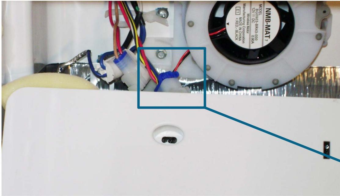
Tight fit for Evaporator fan plug.
