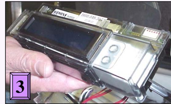
Removing display module
