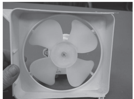
3. Remove fan motor assembly
